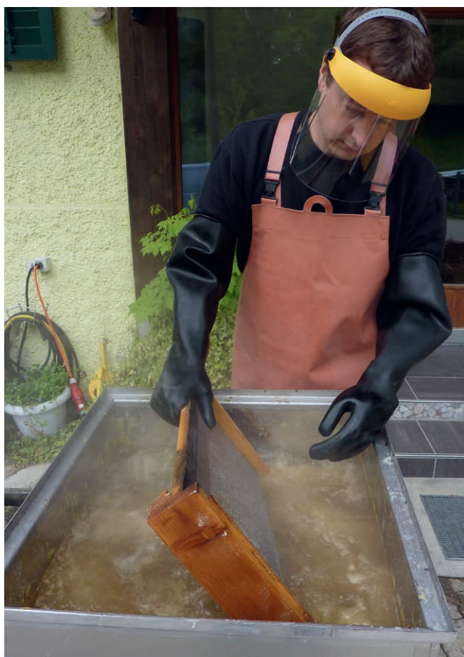
Fig. 7: La soude caustique est plus dangereuse que la soude. Lors de la manipulation de ces deux substances, il faut porter des habits de protection (photo T. Amsler)
